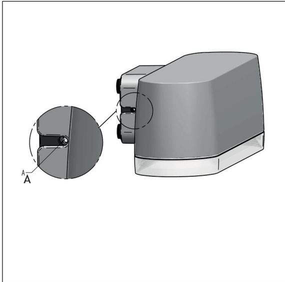
Démontez l'embase à l'aide d'une clé hexagonale de 3 mm pour desserrer les deux vis A. Démontez la fiche B ainsi que le cache-bornes à l'aide des vis C.
