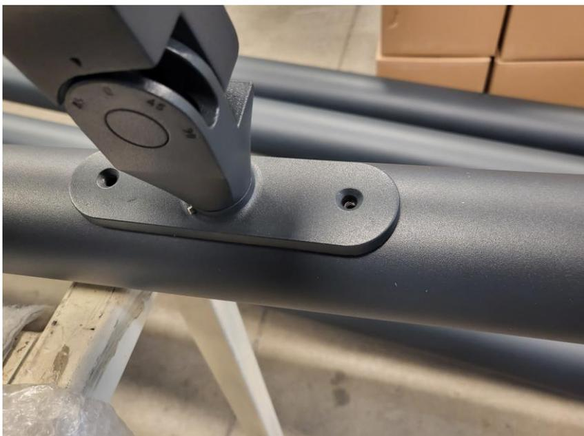
Présenter le projecteur et visser les 2 vis M6, la force de serrage doit être de 1 Kg maximum
