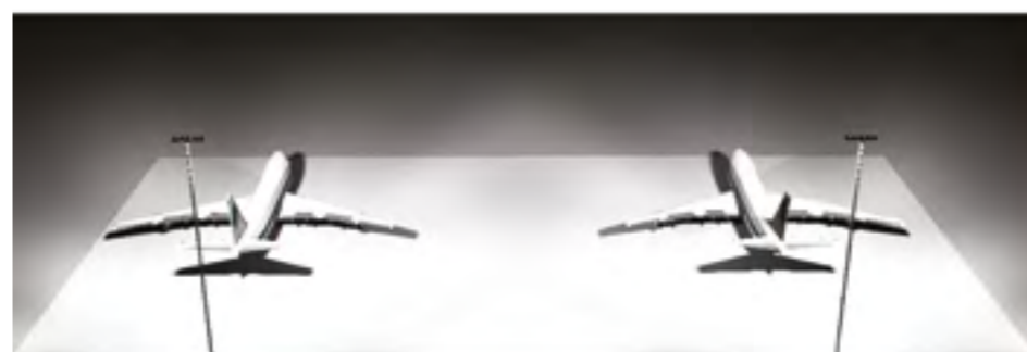
Hauteur de feu 25 mètres, 5 MUSTANG 700 Watts par mât et une interdistance 75 mètres , surface 11 000 m 2 , 50 Lux moyen uniformité moyenne 0,4
